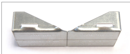
Werkstück - konventionell gekantet.
