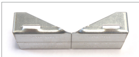
Componente formato utilizzando una matrice convenzionale con piega in aria.
