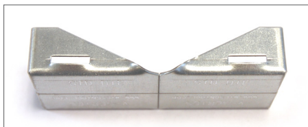
Pièce pliée avec une matrice traditionnelle.
