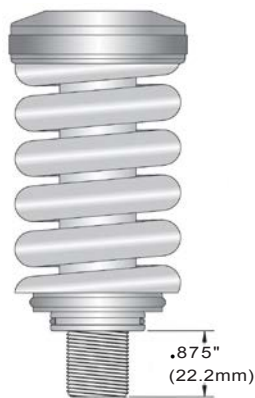
Figura 9: Dimensiones de herramientas de Torreta Alta Estaciones A & B
