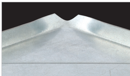
1. Schritt: Vorkanten der Seiten mit aufgeweiteten Ecken
